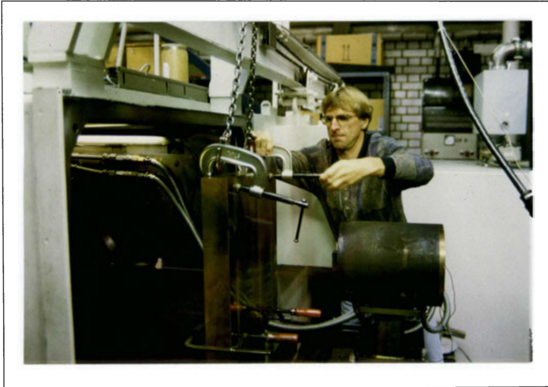
Kuva 2. IGM:n laitteistolla tehtyjä levyhitsauskokeita.
