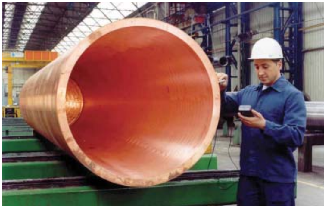
Vallourec & Mannesmann Tubes -tehtaalla valmistettu ensimmäinen integroidulla pohjalla varustettu kapselivaippa esikoneistuksen jälkeen.
