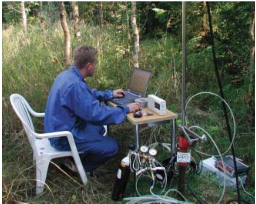
Matalien kallioreikien ja maaperään asennettujen siiviläputkien vedenjohtavuusmittauksia tehtiin tarkoitukseen rakennetulla uudella laitteistolla.
