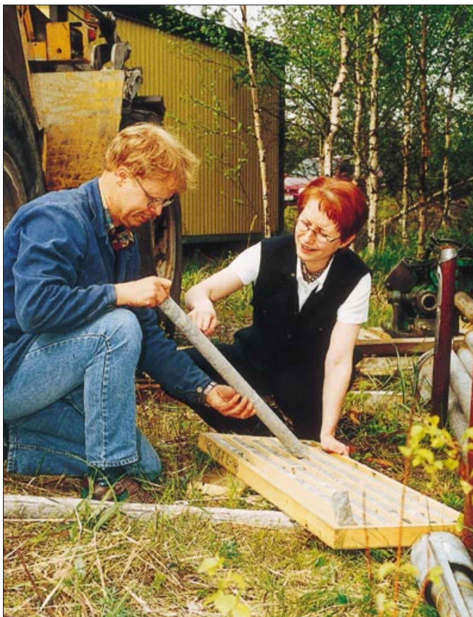
Olkiluodossa kairataan uusia tutkimusreikiä. Geologit Liisa Wikström ja Tauno Rautio tutkivat, miltä kallioperä näyttää satojen metrien syvyydessä.
