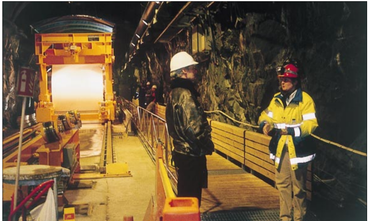
Tiedottaja Sara Björklund esittelee loppusijoitusreikien porauskoetta Äspön kalliolaboratoriossa. Vasemmalla koe-tunnelissa näkyy kiskoilla kulkeva porauskone.
