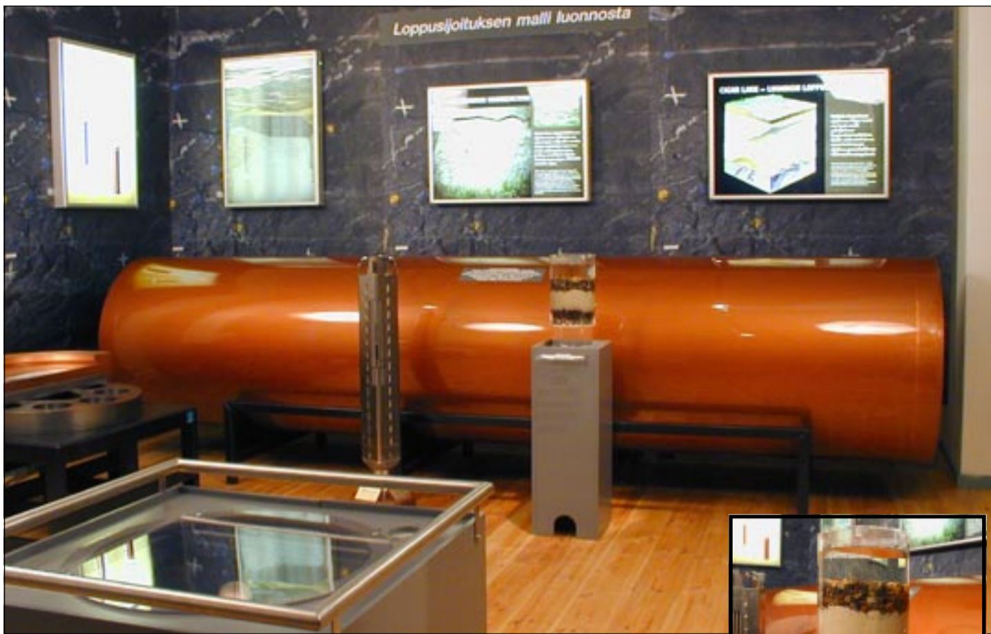
Kuparikapselin pienoismalli havainnollistaa loppusijoitusta (kuva yllä). Bentonitiisavea käytetään loppusijoitusreiässä suojaamaan kapselia vedeltä. Tässä bentonitiisavi estää veden tunkeutumisen reikäpohjaisen lierion läpi (pikkukuva).
