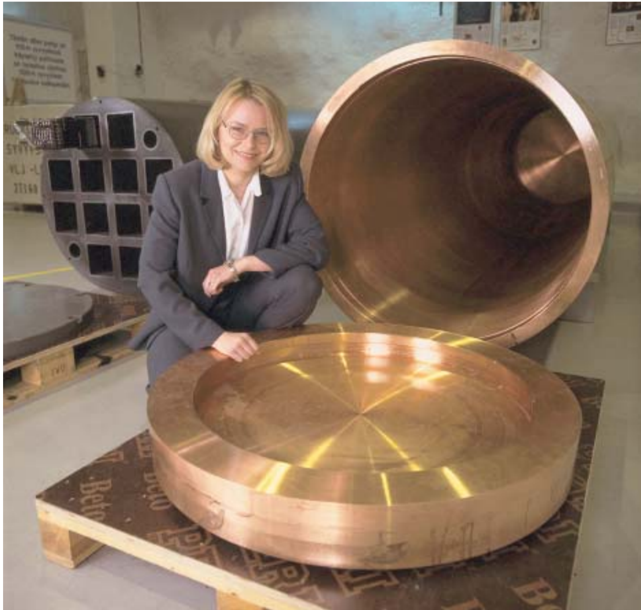
Loppusijoituksen pitkäaikaisturvallisuudessa radionuklidien tärkein vapautumiseste on massiivinen, yli 20 tonnia painava kuparikapseli. Posivassa kuparikapselin suunnittelusta ja kehitystyöstä vastaa kehityspäällikkö Tiina Jalonen.
