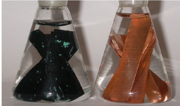
Kuva 1: Koejärjestely, jossa kuparinäytteet ovat olleet vedessä lasiastiassa 15 vuoden ajan. Vasemmassa astiassa vety pääsee kulkeutumaan pois palladium-kalvon läpi. Oikea astia oli kokonaan suljettu (Hultquist 2008).
