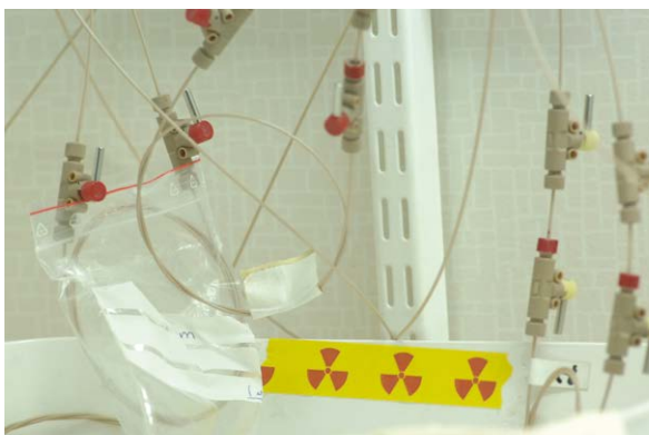
Radionuklidien pidättymiskokeen tutkimuslaitteistoa.
