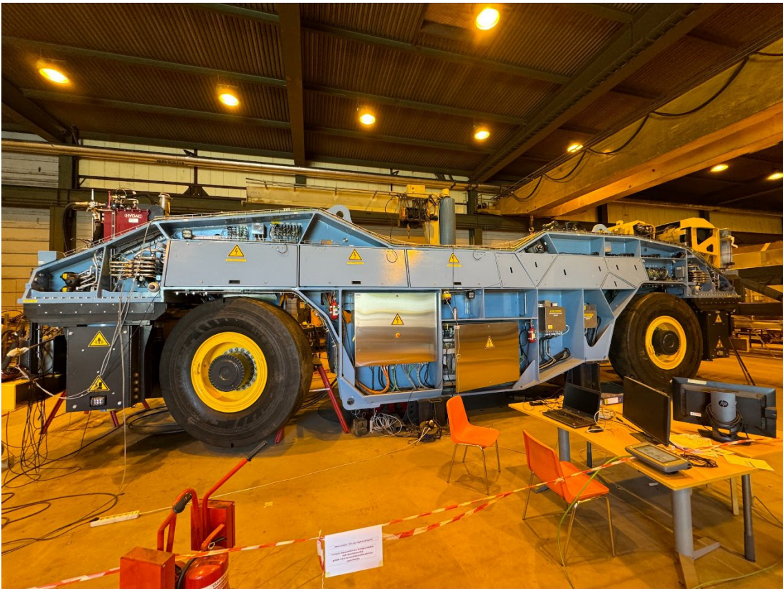
Kuva 4-6. Kapselin siirto- ja asennusajoneuvo tehdasteissä heinäkuussa 2024.
