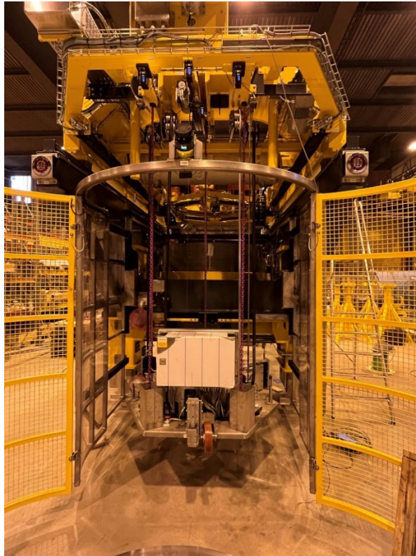
Kuva 4-7. BIS-järjestelmän puskurin asennuslaite on saavuttanut järjestelmätason koevalmiuden.
