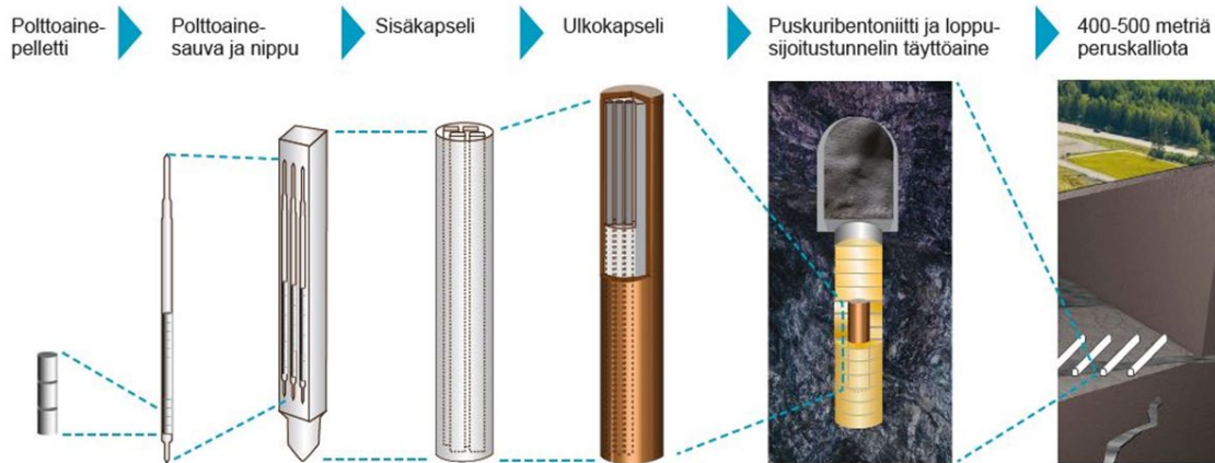
Kuva 4-10. Loppusijoituksen moniesteperiaate.
